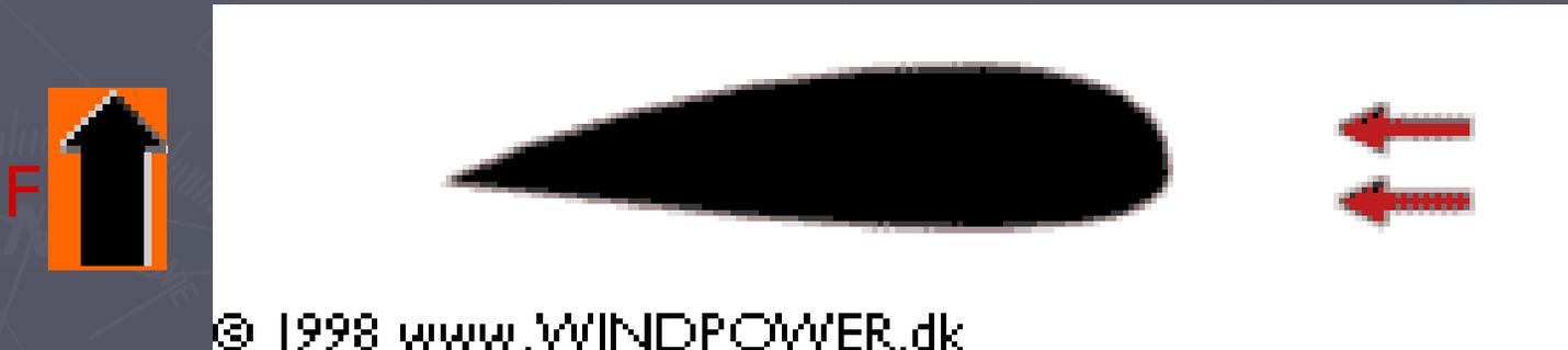
Obsérvese la animación del perfil cortado (sección transversal) del ala de un avión. La razón por la que un aeroplano puede volar es que el aire que se desliza a lo largo de la superficie superior del ala se mueve más rápidamente que el de la superficie inferior. Esto implica (por efecto Venturi) una presión más baja en la superficie superior, lo que crea la sustentación, es decir, la fuerza de empuje hacia arriba que permite al avión volar.
