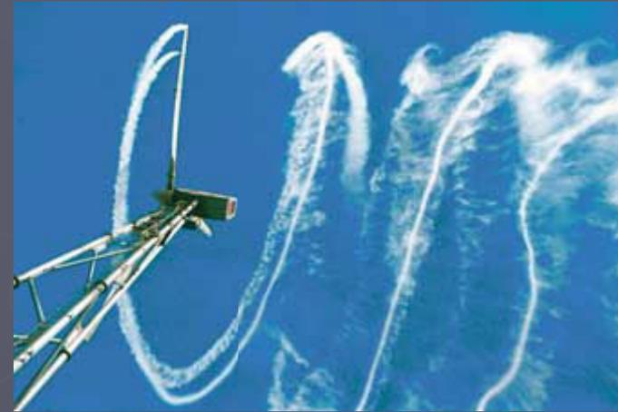
En los parques eólicos, para evitar una turbulencia excesiva corriente abajo alrededor de las turbinas, cada una de ellas suele estar separada del resto una distancia mínima equivalente a tres diámetros del rotor. En las direcciones de viento dominante esta separación es incluso mayor, tal y como se explica en la página siguiente.
