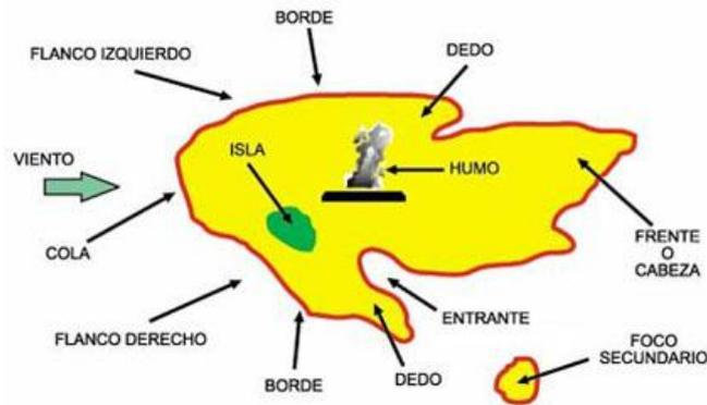
Figura 27. Flancos de las superficies boscosas incendiadas
